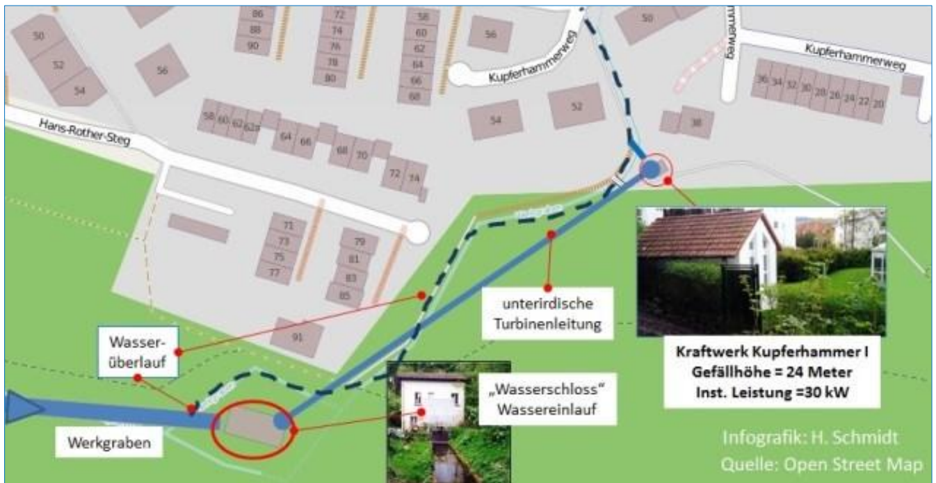
Wasserkraftwerk Kupferhammer I am Urselbach
